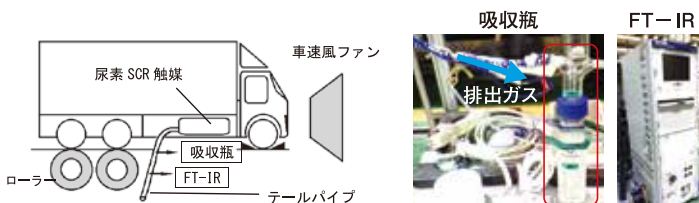
【図1】 シャシダイナモメータによる排出ガス試験
