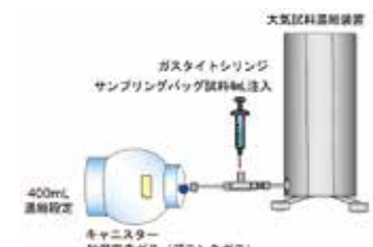
【図2】 サンプルングバッグからキャニスターへ対応型大気試料濃縮装置への試料導入方法
