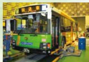
▲ 用于大型车辆的底盘测功机
