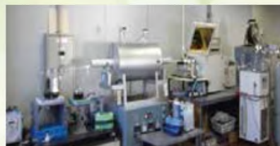
▲ 水银气体的吸附/反应处理实验装置
