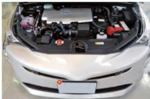
④ ラジエーターサポートオープニングカバー ⑤ フロントバンパーエクステンションマウンティング
