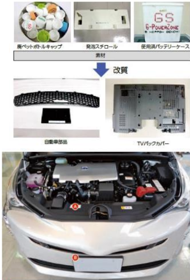
A ラジエータサポートオープニングカバー B フロントバンパーエクステンションマウンティング
